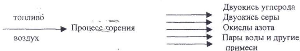
Для расчетов материальных потоков веществ при сжигании органического топлив; используются реакции горения основных его компонентов: углерода, водорода и серы. **Реакции горения основных компонентов органического топлива**
